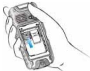
5. Установите на место батарею и крышку. Заверните винты крепления крышки отделения для батареи (в направлении по часовой стрелке), чтобы закрепить крышку.
