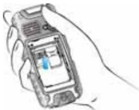
4. Вставьте карту памяти SD в гнездо и закройте серебристый фиксатор.
