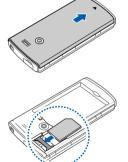
Снимите крышку отсека аккумулятора.
