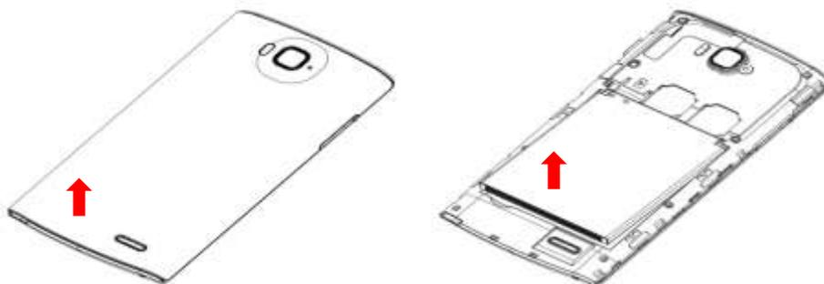
Для того, чтобы установить аккумулятор, пожалуйста, снимите заднюю крышку и поставьте аккумулятор в аккумуляторный отсек, сопоставьте контакты с контактами телефона.
