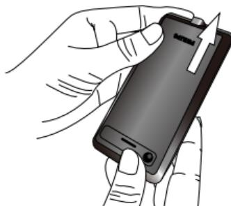
Перед началом пользования телефоном удалите защитную пленку с дисплея и объектива камеры.
