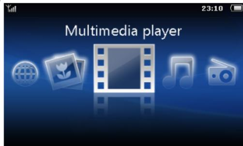
На этом экране функций мультимедиа нажмите пиктограмму *Браузер* для перехода в сеть Интернет, *Просмотр изображений* – для отображения картинок, *Видео плеер* или *Аудио плеер* – для воспроизведения видео- и аудиофайлов или *FM радио* – для прослушивания радиопрограмм. Более подробное описание приведено в "Медиа" на стр. 65.
