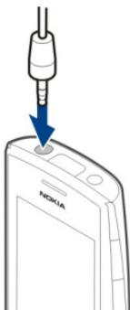
Не подключайте аппаратуру, которая формирует выходной сигнал, поскольку в результате устройство может оказаться повреждено. Не подключайте источники напряжения к разъему AV Nokia. При подключении к разъему AV Nokia внешнего устройства или минигарнитуры, отличных от рекомендованных корпорацией Nokia для данного устройства, уделите особое внимание уровню громкости.
