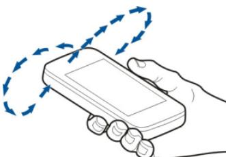
Компас имеет ограниченную точность. Электромагнитные поля, металлические объекты и другие внешние факторы также снижают точность показаний компаса. Компас должен быть правильно откалиброван.
