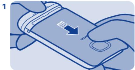
Снимите заднюю панель.
