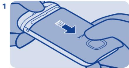
Выключите телефон, затем снимите заднюю панель.
