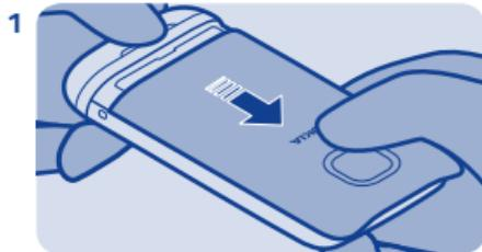
Снимите заднюю панель.
