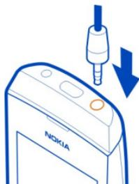
Не подключайте аппаратуру, которая формирует выходной сигнал, поскольку в результате устройство может оказаться повреждено. Не подключайте источники напряжения к разъему AV Nokia. При подключении к разъему AV Nokia внешнего устройства или минигарнитур, отличных от рекомендованных для данного устройства, уделите особое внимание уровню громкости.
