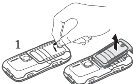
2. Чтобы извлечь аккумулятор, поднимите его, как показано на рисунке.
