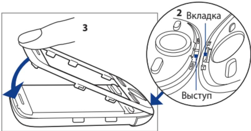
**4.** Вставьте аккумулятор на место и затем наденьте новую заднюю крышку.
