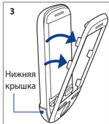
4. Начав с одной стороны, приподнимите край нижней крышки, пока ее выступ не выйдет из зацепления с корпусом телефона.
