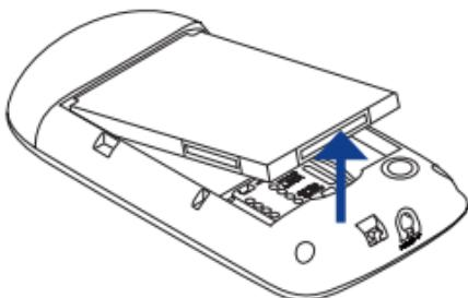
Чтобы в следующий раз извлечь аккумулятор, подцепите его в пазе отсека аккумулятора.
