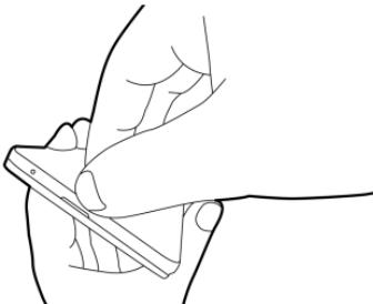
3. Снимите заднюю панель.
