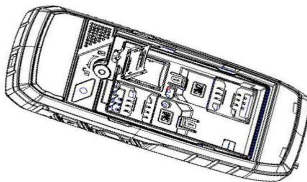
Телефон позволяет использовать одновременно две SIM-карты (Модуль Идентификации Абонента) различных мобильных операторов стандарта GSM. На SIM-картах хранится информация, необходимая для подключения телефона к сетям операторов сотовой связи, личная информация, такая как PIN-код (Персональный Идентификационный Номер), записи телефонной книги, сообщения и другие услуги системы.
