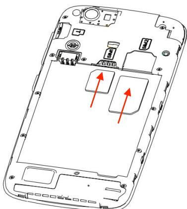
**Внимание!** Один из слотов предназначен для микро-SIM, а другой – для стандартной SIM-карты. Micro-SIM — обновлённая и миниатюрная альтернатива SIM-карты для идентификации абонентов на мобильных
