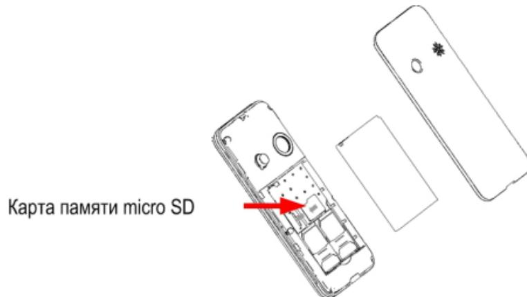
Извлечение аккумулятора, SIM карт и micro-SD карты производится в обратном порядке.
