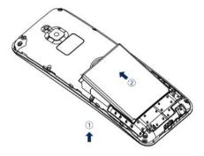
✓ Закройте крышкой аккумуляторный отсек и нажмите на неё до полной фиксации.
