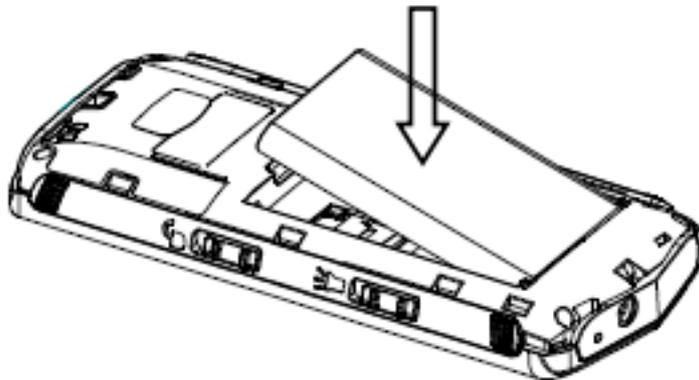
Установите на место заднюю крышку. Для этого наложите ее сзади на аппарат и надавите до щелчка.
