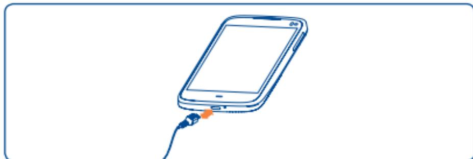
Подключите телефон к зарядному устройству, загорится индикатор зарядки в нижней части телефона.
