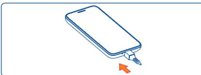
Подключите зарядное устройство к телефону и стандартной бытовой розетке переменного тока (220 В, 50 Гц), как показано на рисунке, загорится светодиодный индикатор.
